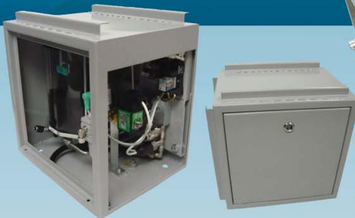
Mazací systém OK-01 je určen k mazání okolků tramvají, které nejsou vybaveny vlastním rozvodem tlakového vzduchu. Systém pracuje na principu nanášení směsi maziva na styčné plochy okolků kol tramvají s kolejnicemi pomocí tlakového vzduchu.
